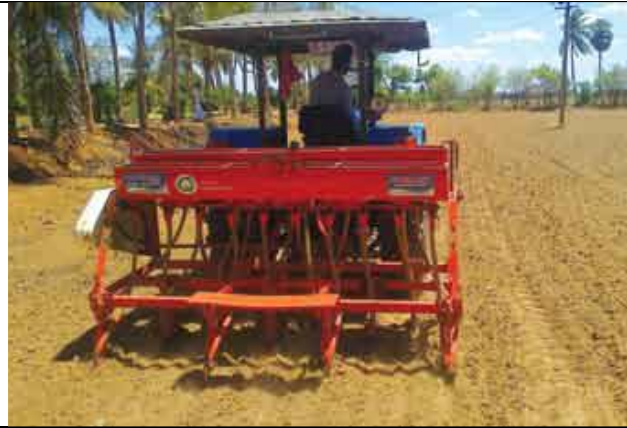
फोटो ६. परम्परागत पद्धतीबाट खनजोत गरेको चार पाङ्ग्रे ट्र्याक्टरमा सिड ड्रिल मेसिन जोडी छरुवा धान रोप्दै ।
